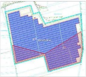
Abbildung 1: Ursprüngliches Konzept. Rot markiert: Bereiche von denen Blendwirkungen ausgehen können. [12]
